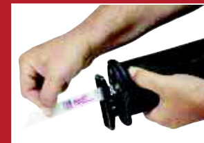
FIXTEC™ fűrészlap leszorító és könnyű kulcsnélküli fűrészlap csere
