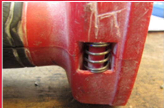
A kívülről összeszerelt rugó bizonyítja a szerszám jogosulatlan kinyitását
