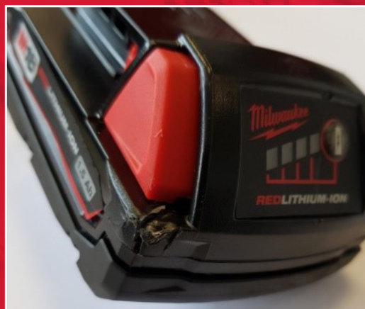
Példa a MILWAUKEE® akkumulátor erőteljes leesésére vagy ütésére
