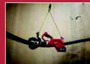
A kiegyensúlyozott kialakítás, fogantyú és horog lehetővé teszi a legegyszerűbb beállítást a boltívekben
