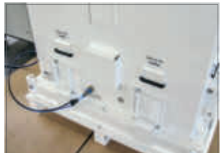
Vízgőzálló tartály túlnyomással végzett tömítésvizsgálattal
